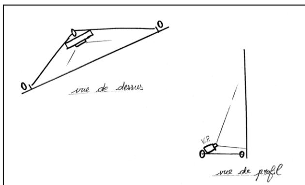
Projections vidéo sur scène : deux châssis autonomes, mobiles sur roulettes, l'un de 3m de haut x 1,70m de large, l'autre de 3m de haut x 4m de large avec vidéoprojecteur intégré en rétro projection.
